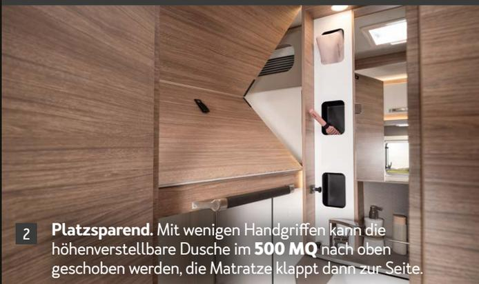
2 **Platzsparend.** Mit wenigen Handgriffen kann die höhenverstellbare Dusche im **500 MQ** nach oben geschoben werden, die Matratze klappt dann zur Seite.
